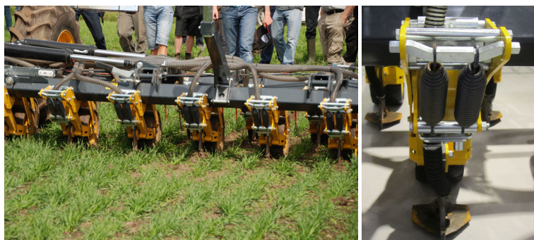
Billede 6. Hvert skær er styret af sit eget dybdestyringshjul. Foto: Inger Bertelsen og Henning Sjørsløv Lyngvig, VFL
