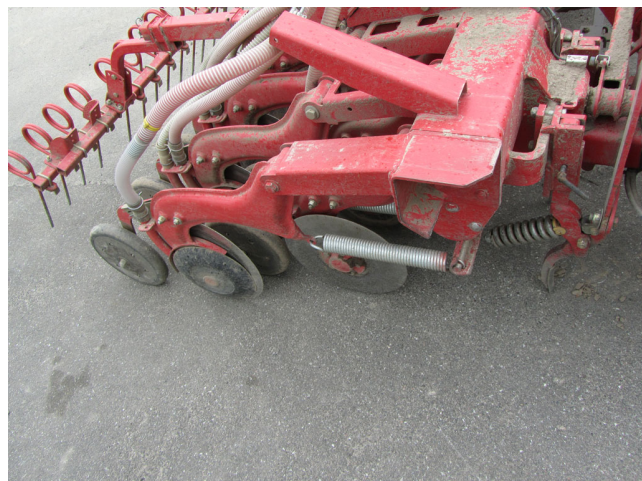
Billede 2. Såmaskinen er udbygget med én sånhet for at få rækkeafstandene ens mellem såtrækkene. Foto: Henning Sjørlev Lyngvig, VFL
