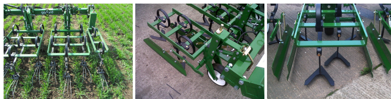
Billede 7. Skæropsætning til korn på 25 cm, roer på 50 cm og majs på 75 cm. Foto: Henning Sjørsløv Lyngvig, VFL og Garford
